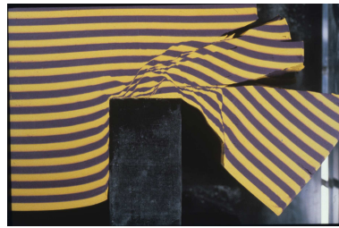
FIGURE 2 – Evolution de la déformation plane lors de l'indentation d'une couche de plasticine par un poinçon rigide
