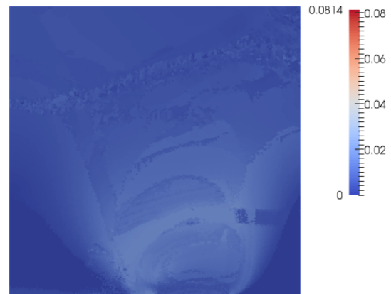
FIGURE 5.46 – Expérience 5- Profil de la norme matricielle du tenseur plastique |p(t, \cdot)| au temps t = 2 .
